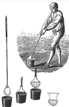
تصویر 1. روش ساخت دمیدن در قالب. www.rhenfit.delglass
